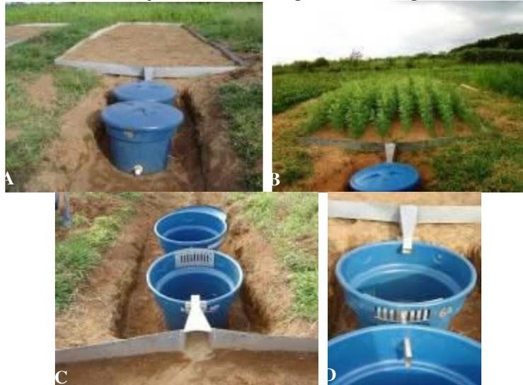
**Figura 1.** Parcela de perda de solo (A); parcela com planta de cobertura instalada (B); coletores e caixas para coleta de água e sedimentos (C); detalhe do divisor Geib com nove janelas (D).
