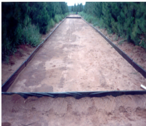
Figura 1 – Segmento de estrada florestal e coletores de água de chuva. Figure 1 – Forest road segment and rain water collectors.
